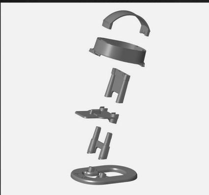
ENSAMBLAJE DE PUESTO DE LENTES DE VISIÓN NOCTURNA
